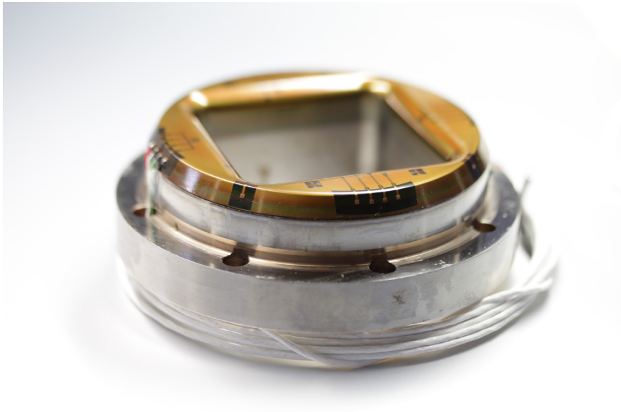
Abb. 1: Tiefzieheinsatz mit multifunktionalem Schichtsystem auf der Oberfläche zur lokalen Temperatur- und Druckverteilungsmessung
