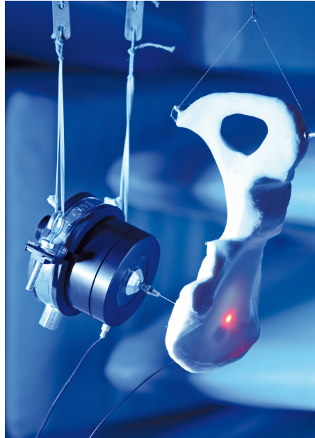
Abb. 3: Durch einen elektrodynamischen Shaker angeregtes Hüftbein zur Modalanalyse für die biomechanische Charakterisierung
