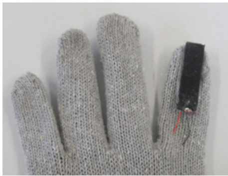
Abb. 3: Flexibler Drucksensor zur Erfassung von Greifkraft
