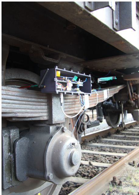
Abb. 1: Energieautarker Sensorknoten im Feldversuch
