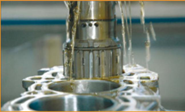
Formhlonwerkzeug mit Piezoaktoren. (Foto: Fraunhofer IWU)
