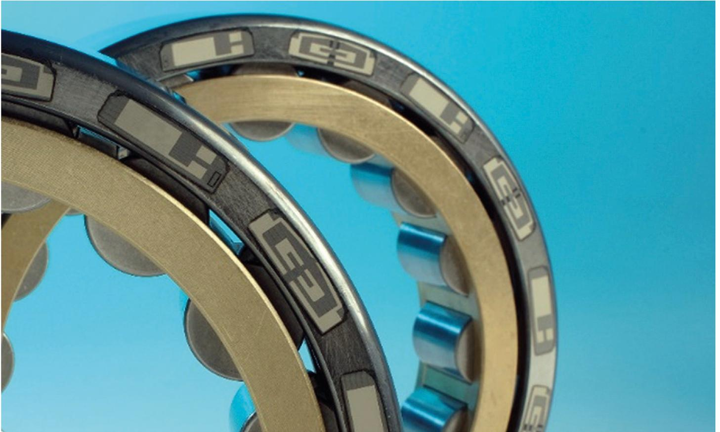
Abb. 1: Demonstratorbaugruppe: Sensoren gedruckt und laser-gesintert auf Wälzlager (Quelle: Fraunhofer ILT)
