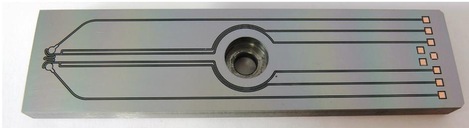
Abb. 11: Werkzeugeinsatz mit vollständigem verschleißbeständigem Sensorsystem auf der Oberfläche
