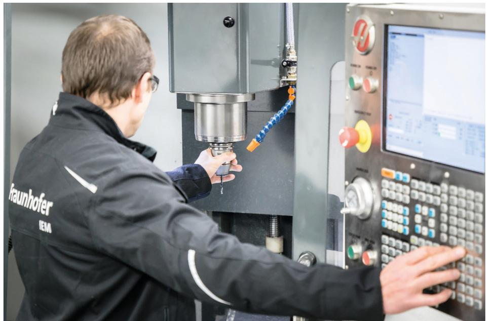
Abb.2: Bauteilbearbeitung mit einer NC-Fräsmaschine
