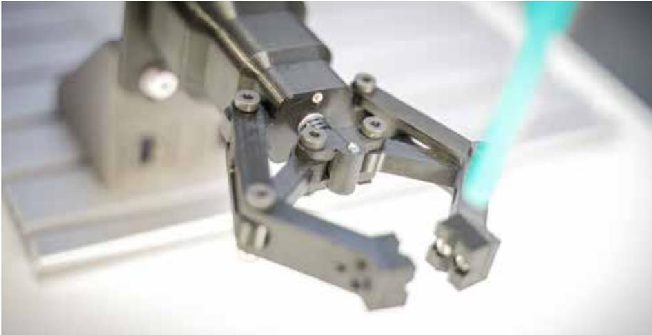
Abb.: Kraftsensitiver Greifarm für empfindliche Bauteile
