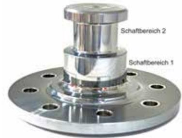
Abb. 2: Anordnung von waagrecht verlaufenden linienförmigen piezoresistiven Sensorstrukturen im Schaftbereich 1 des King Pins. Dort treten die Sensorstrukturen in direkten Reibkontakt mit dem Verschleißring und messen die Zug- und Schubkräfte. Zusätzlich sind in nächster Nähe mäanderförmige Temperatursensoren angeordnet. Außerdem sind im unbelasteten Bereich die DMS-Vollbrücken strukturiert, welche die lokale Dehnung langzeitstabil messen werden.
