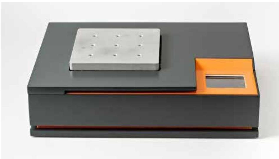
Abb.2: Mechanische Hardware-in-the-Loop-Schnittstelle. (Foto: Fraunhofer LBF).
