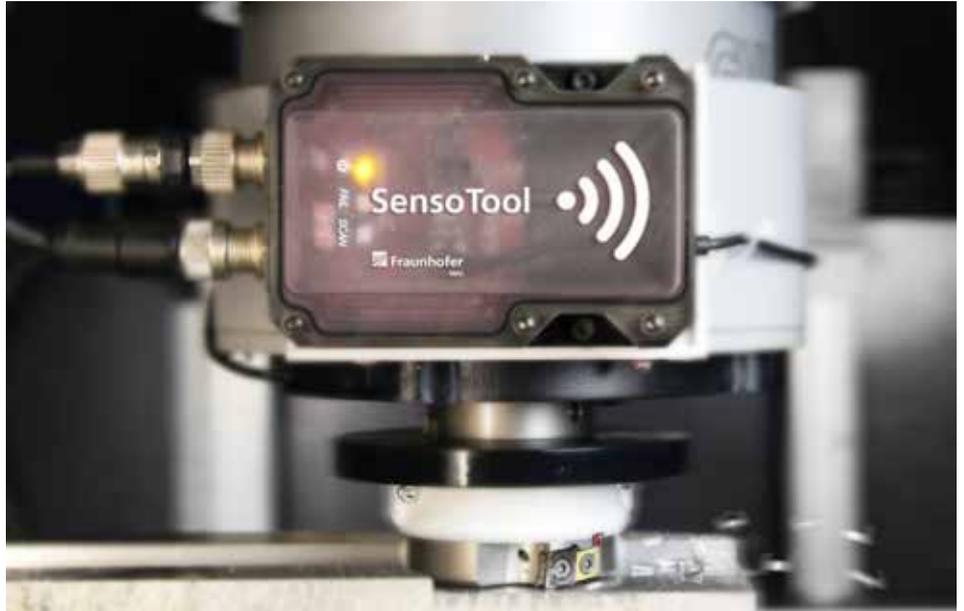
Abb.: Das sensorische Werkzeug ›SensoTool‹ ermöglicht eine exakte Charakterisierung von Fertigungsprozessen.
