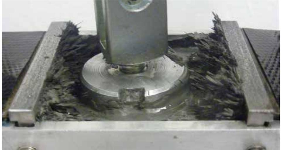
Abb. 2: Testkörper in durch Magnetfeld versteifter MRF (Quelle: Fraunhofer ISC)
