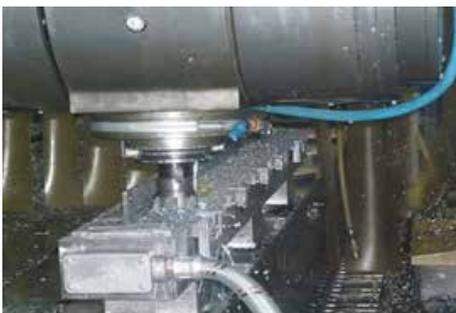
Abb. 3: Fräsprozess an T-Stringer aus Titan in einer im Magnetfeld versteiften MRF (Quelle: Fatronik-Tecnalia)
