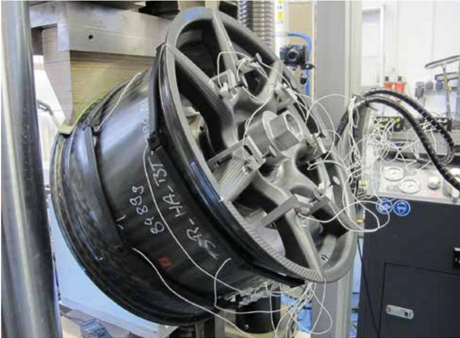
Abb.1: Mit Schallemissionssensoren instrumentiertes Leichtbaurad während quasistatischer Ermüdungstests auf einer Universalprüfmaschine
