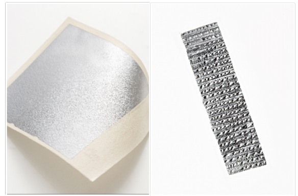
Abb. 2. Typen von Piezoelekturen. Links: Irradiation cross-linked Polypropylen (IXPP). Rechts: Parallel-Tunnel FEP
