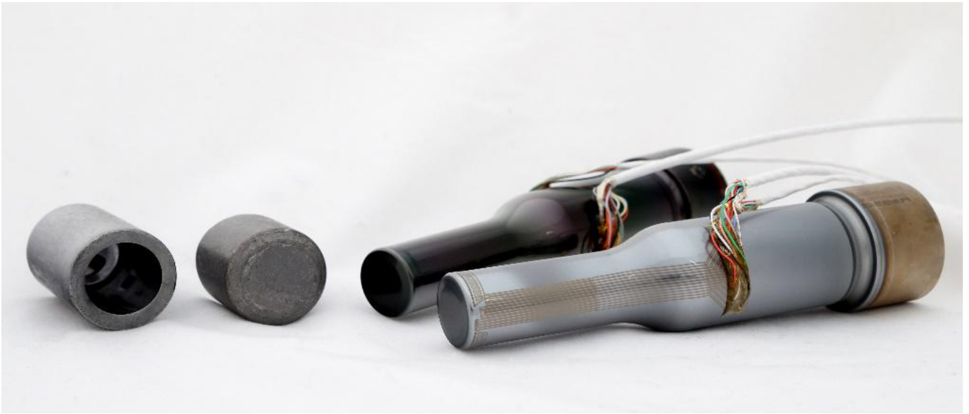
Umformstempel mit Dünnschichtsensorik zur Temperatur- und Verschleißmessung
