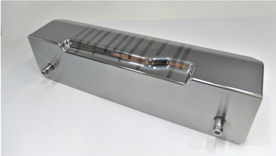
Gesenkhälfte für die Halbwarmumformung mit thermoresistiven Dünnschichtsensoren
