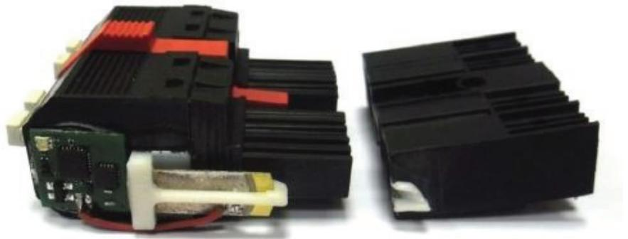
Demonstratorsystem bestehend aus dem Stecker mit aktiven Komponenten und der Buchse
