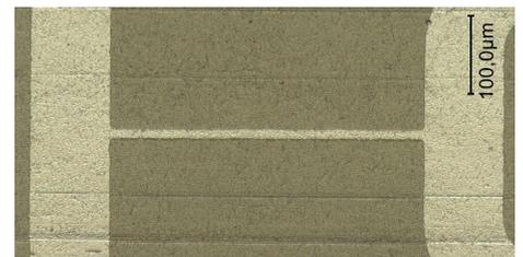
Mikroskopaufnahme einer 10 µm Sensorstruktur auf einer gekrümmten Zahnradflanke
