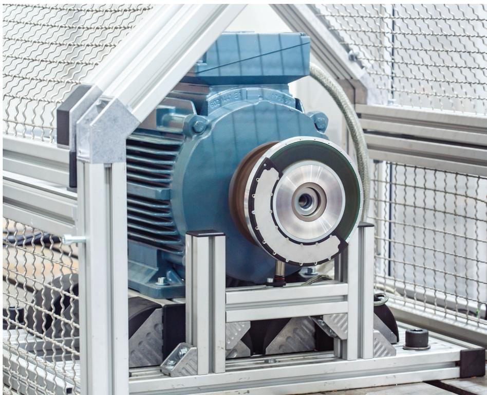
Frontansicht des Energy Harvesters bei einer Rotordrehzahl von ca. 650 min<sup>-1</sup>
