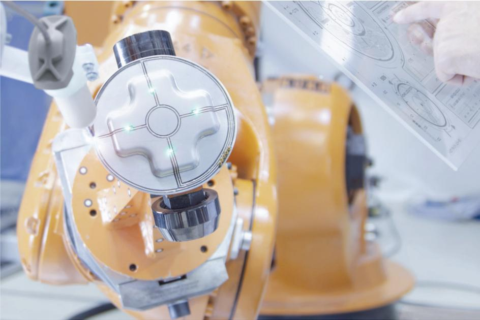
Roboter druckt eine Leiterbahn zur Ansteuerung von LEDs auf einem umgeformten Blechteil
