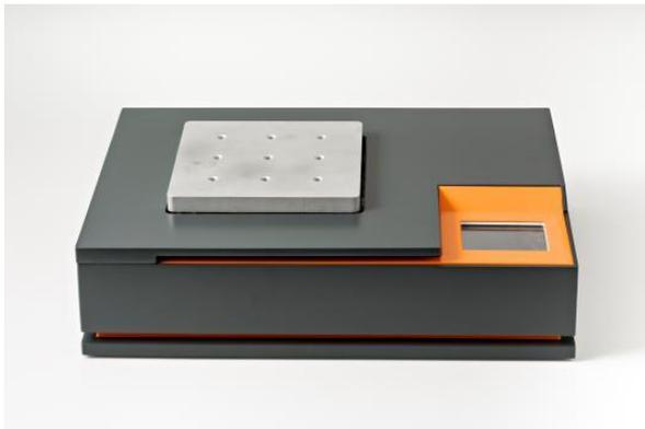
Mechanische Hardware-in-the-Loop-Schnittstelle. Foto: Fraunhofer LBF / Raapke.
