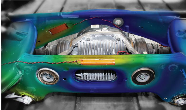
Abb.1: Aktives System zur Reduktion von Hinterachsgeräuschen auf Basis von Piezo-Flächenwandlern
