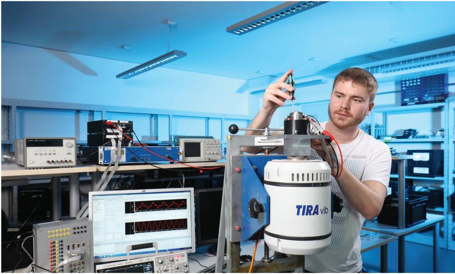
Abb.1: Teststand zur Charakterisierung von abstimmbaren Vibrationswandlern am Fraunhofer IIS ©Fraunhofer IIS/Kurt Fuchs
