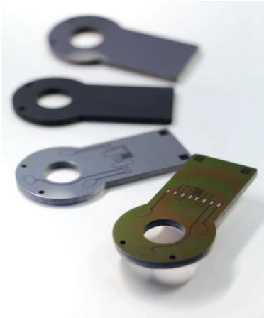
Abb. 1: Fertigungsschritte des sensorischen Dünnschichtsystems auf Unterlegscheibengrundkörpern.
