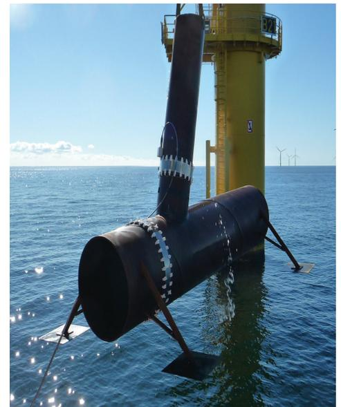
Abb.2 : Sensormanschette am Modell einer Gründungsstruktur für Auslagerungstests
