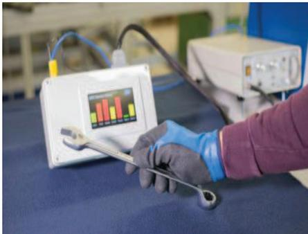
Abb. 2: Handschuh mit Sensorik zur Erfassung von Greifkräften © K. Selsam-Geißler, Fraunhofer ISC
