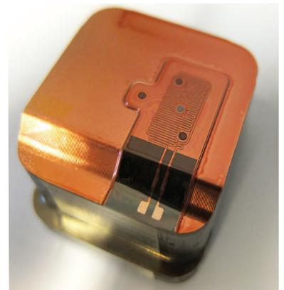
Abb. 3: Kunststoffspritzgusswerkzeug mit Heizstruktur aus Kupfer.
