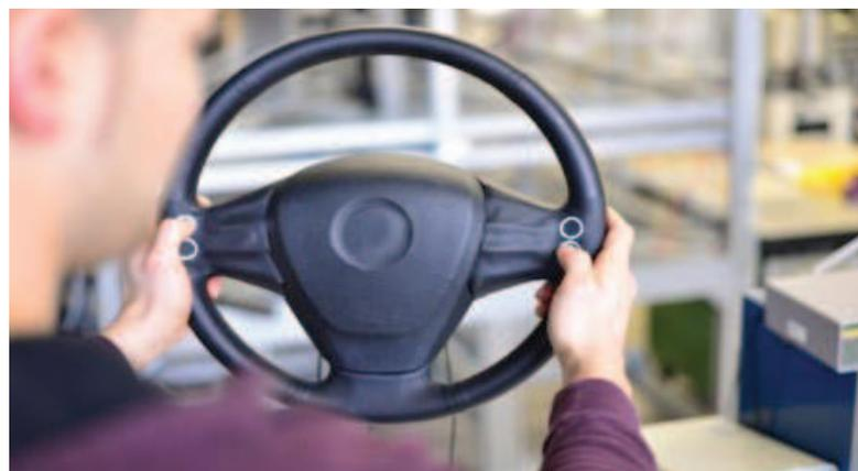
Abb. 3: Bedienelemente aus kapazitiven Sensoren zur Steuerung von technischen Funktionen auf Lenkrad © K. Selsam-Geißler, Fraunhofer ISC
