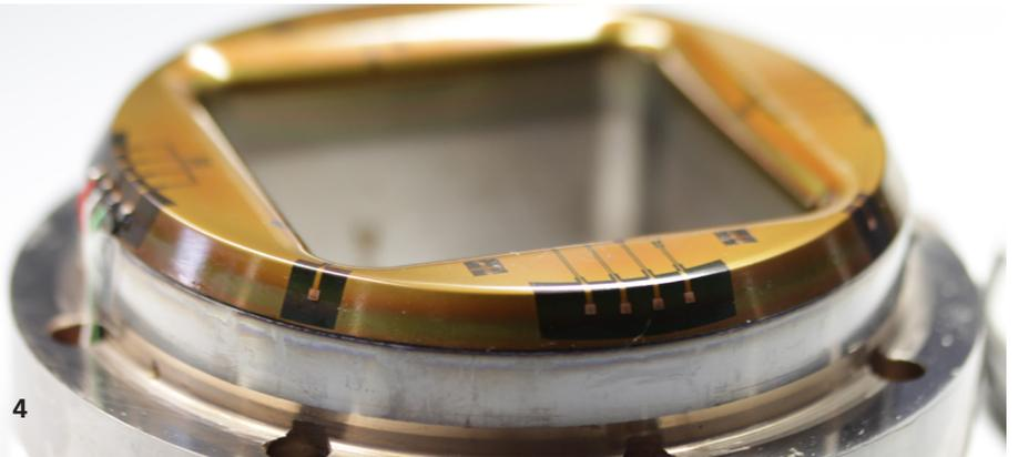
Der schematische Aufbau des Schichtsystems ist in Abbildung 3, das Werkzeug mit vollständigem Dünnschichtsensorium in Abbildung 4 dargestellt. Die vierte Abbildung zeigt auch die Komplexität der Sensorstrukturierung: Die Kontakte sind auf der äußeren schrägen unbelasteten Fläche angeordnet, die Messstellen hingegen auf der Oberseite bzw. innerhalb der zweiten Krümmung des Werkzeugs.
