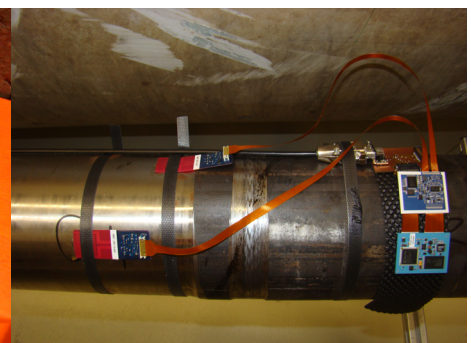
Bild 2: Laboraufbau zur Bestimmung der Wandstärke.
