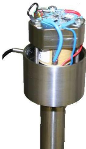
**Bild 2:** Erprobung im Kraftwerk mit gekapselter Elektronik und Sensorik im akustischen Wellenleiter.
