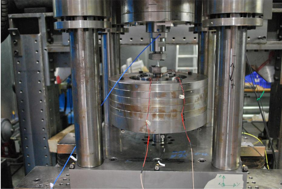
*Piezokeramischer Inertialmassenaktor zur Bauteilprüfung*
