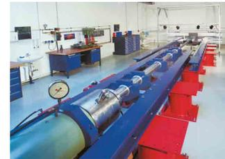
Die Komponenten-Crashanlage des Fraunhofer EMI
