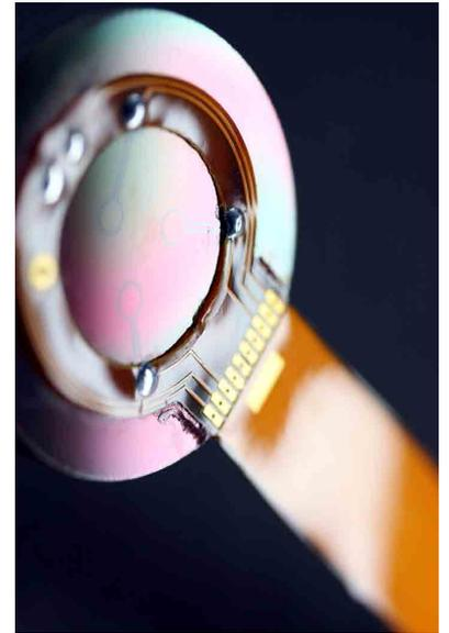
Sensormodul zur Überwachung von Schneidprozessen
