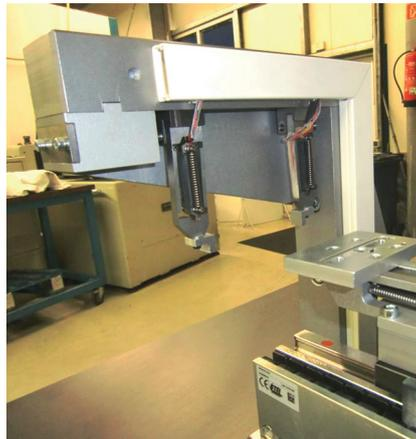
Piezoelektrische Hubachse und Greifer
