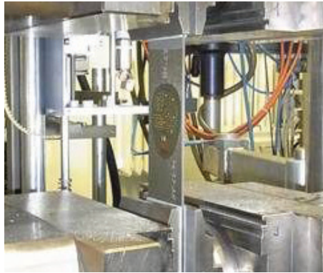
Dynamische Zugbeanspruchung des eingebetteten Sensorsystems ( R=0,1 )
