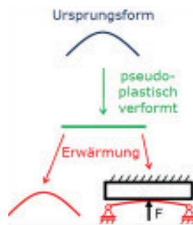
Wirkprinzip des Formgedächtniseffektes für einen FGL-Blech-Aktor
