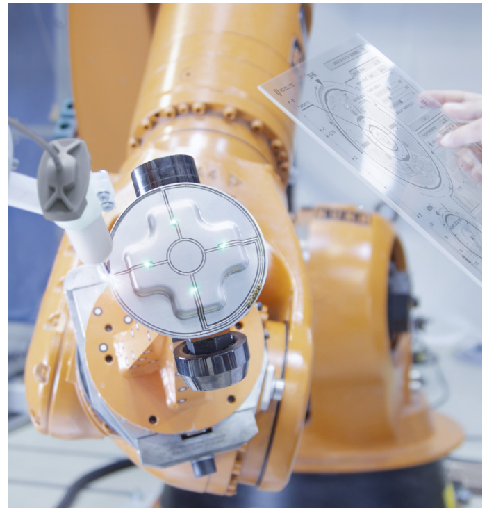
Roboter druckt eine Leiterbahn zur Ansteuerung von LEDs auf einem umgeformten Blechteil.
